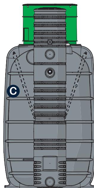
1. Après avoir retiré les bouchons de protection de la cuve, emboîter le manchon (fourni) dans la connexion au niveau supérieur de la cuve, et insérer la réduction 110-75 dans la connexion en partie basse. Faciliter l'emboîtement avec de l'eau savonneuse ;
